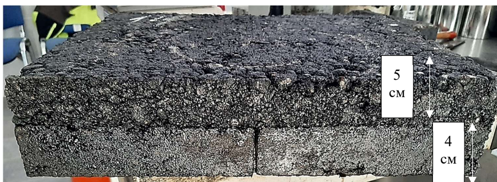
Рисунок 2 — Зразок-плита для випробування на визначення глибини колії
