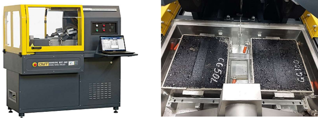
Рисунок 3 — Установка для випробування на колійність і розміщення зразків-плит у формах
